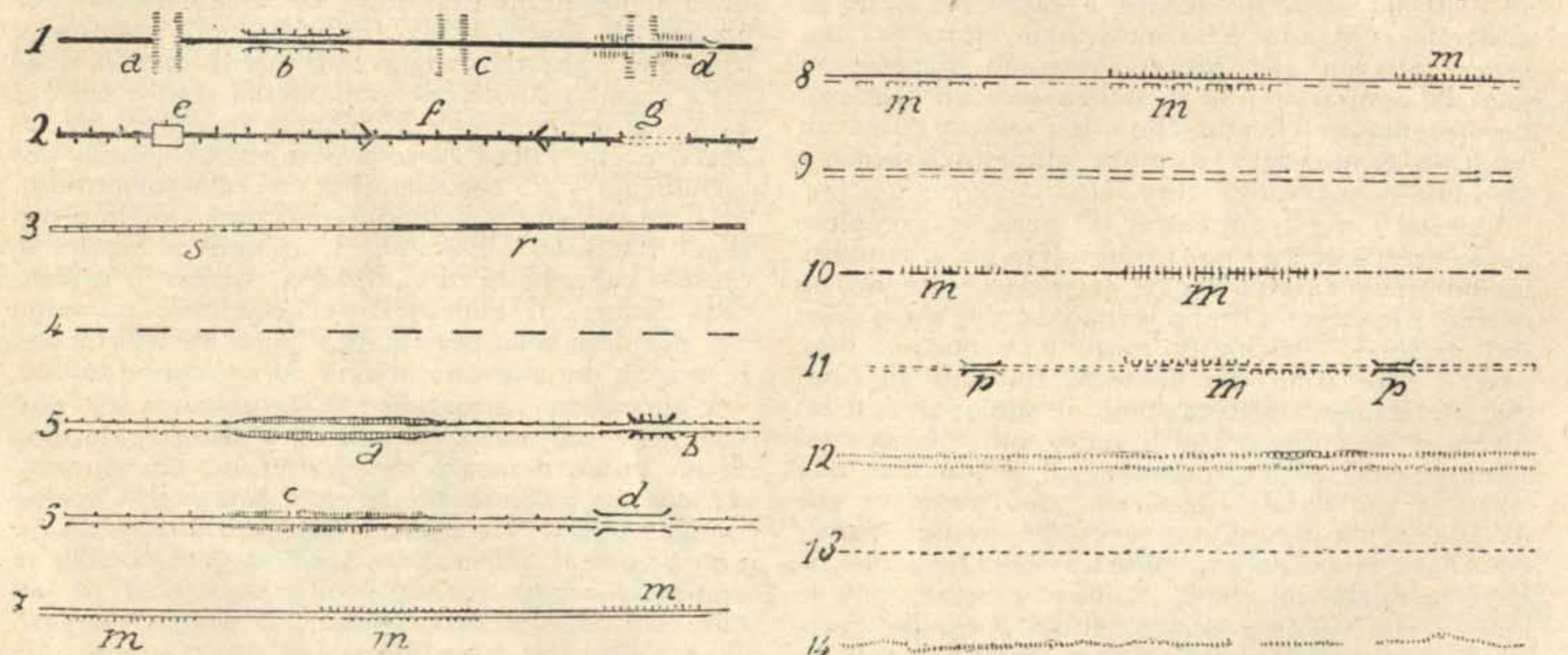
Fig. 12. — Segni convenzionali usati nelle carte topografiche militari: 1, Ferrovia a semplice binario ( a , cavalcavia; b , ponte in muratura; c , passaggio a livello; d , sottopassaggio); 2, Ferrovia a doppio binario ( e , stazione; f , ponte in ferro; g , galleria); 3, Ferrovia a scartamento ridotto o tramvie a vapore ( s , su strada ordinaria; r , su sede propria); 4, Ferrovia in costruzione; 5, Strada carrozzabile di 1 a classe, larga almeno 6 metri ( a , incassata; b , ponte in muratura); 6, Strada carrozzabile di 2 a classe, larga meno di 6 m., a fondo artificiale ( c , in rialzo; d , ponte in ferro); 7, Strada di 3 a classe, a fondo naturale buono ( m , fiancheggiata da un muro, da una parte sola o da entrambe); 8, Strada di 4 a classe, fondo naturale mediocre, servizio di campagna; 9, Strada in costruzione; 10, Mulattiera ( m , fiancheggiata da muri); 11, Strada campestre ( p , ponte in legno); 12, Tratturo: cammino spazioso, ma appena segnato, in pianura; 13, Sentiero, per lo più di montagna; 14, Sentiero difficile di montagna, con interruzioni.
